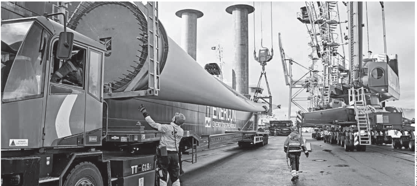
Windkraft pur: Der mit einem Flettner-Antrieb ausgerüstete Schwergutfrachter „E-Ship 1“ übernimmt Rotorblätter für Windkraftanlagen im Hafen Emden
